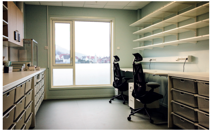
Medisinrom med vinylbelegg på gulv, gips på vegger og systemhimling.
